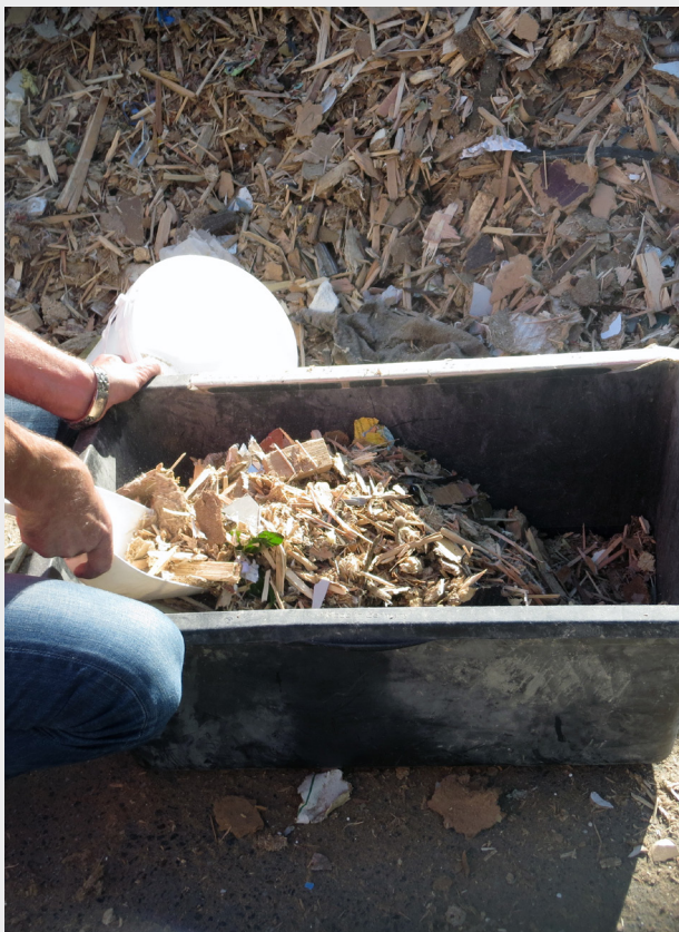
Abwechselndes Befüllen des Eimers und Verwerfen mit der Schaufel
