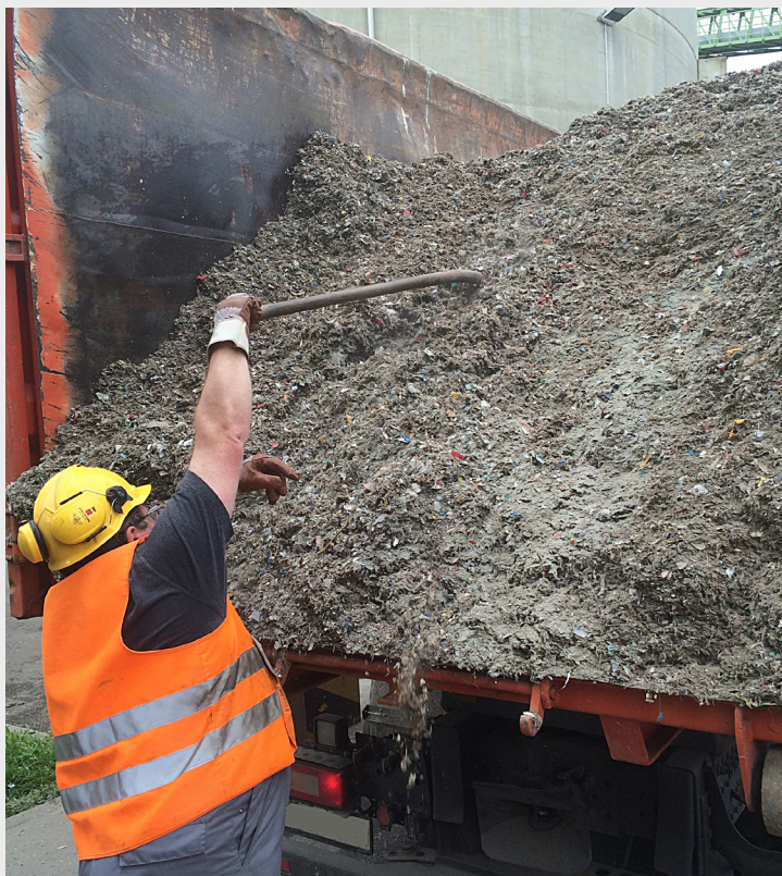
Abbildung 6: Geräte zur Probenahme aus fallendem Materialstrom während der LKW-Entladung
