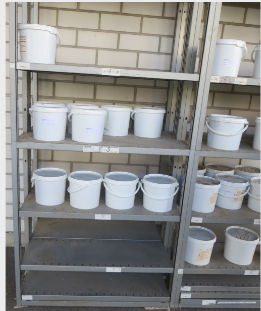
Ein Regal mit Rückstellproben für diverse Sekundärbrennstoffe in Kunststoffeimern mit Klemmdeckeln.
