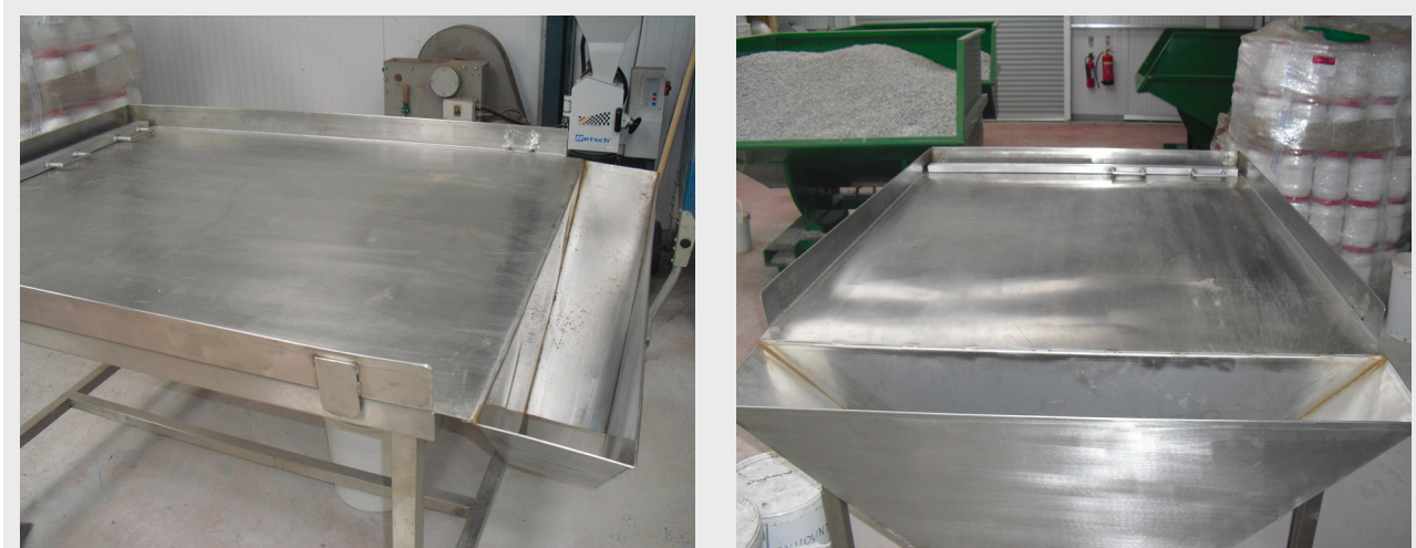
Tisch zur Probenhomogenisierung und Probenverjüngung durch Vierteln und Teilen: Der angeflanschte Trichter erleichtert das Abtrennen des Verwurfes von der Laborprobe. Der Verwurf wird einfach in einem Eimer aufgefangen, der unter den Trichter gestellt wird
