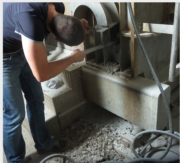
Abbildung 3: Seitliche Öffnung am Bandabwurf: Entnahme der Probe mittels Probenkäscher
