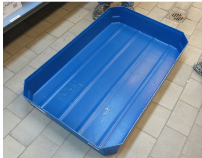
Abbildung 12: Beispiel einer Mischwanne zum Homogenisieren der Einzelproben von Fangstoff
