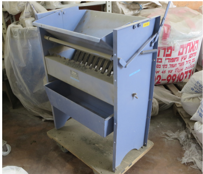
Abbildung 16: Beispiel eines Riffelteilers
