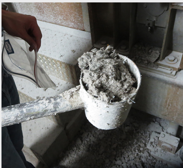
Abbildung 3: Seitliche Öffnung am Bandabwurf: Entnahme der Probe mittels Probenkäscher
